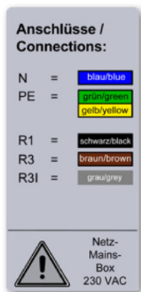
Abb. 5: Anschluss der Relais an die Sensor Box
