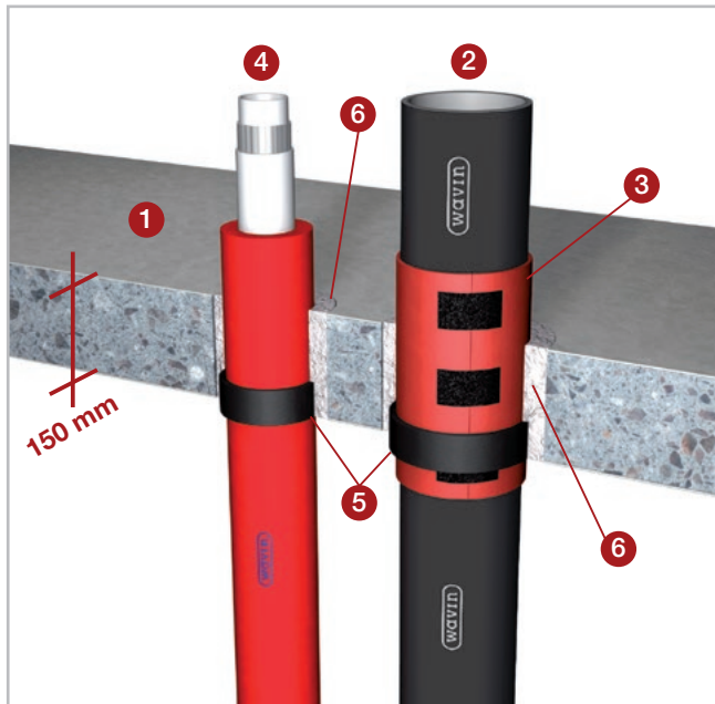
Gerade Rohrführung durch Decke.
